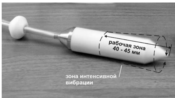
Рис.6. Рабочая часть вибратора и зона вибрации.
