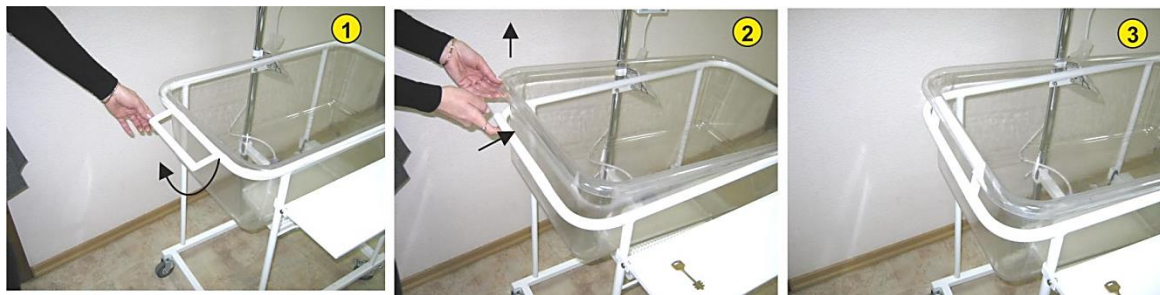
Рис.4. Установка кувеза в наклонное положение.
