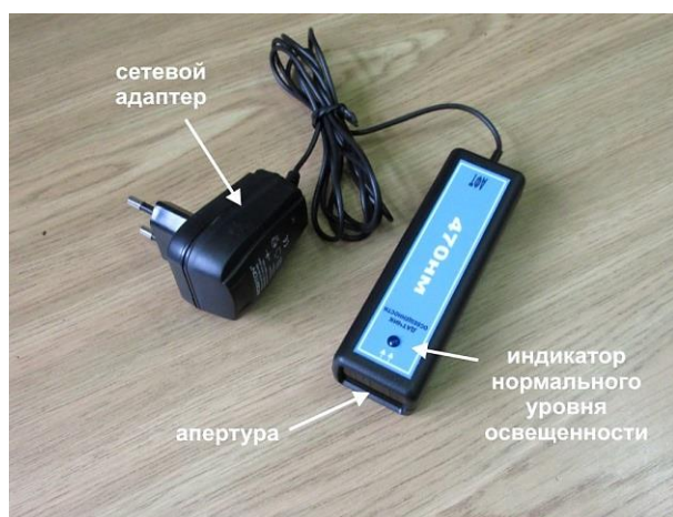
Рис. 7. Датчик контроля уровня освещенности для аппарата "СВЕТОНЯНЯ".
