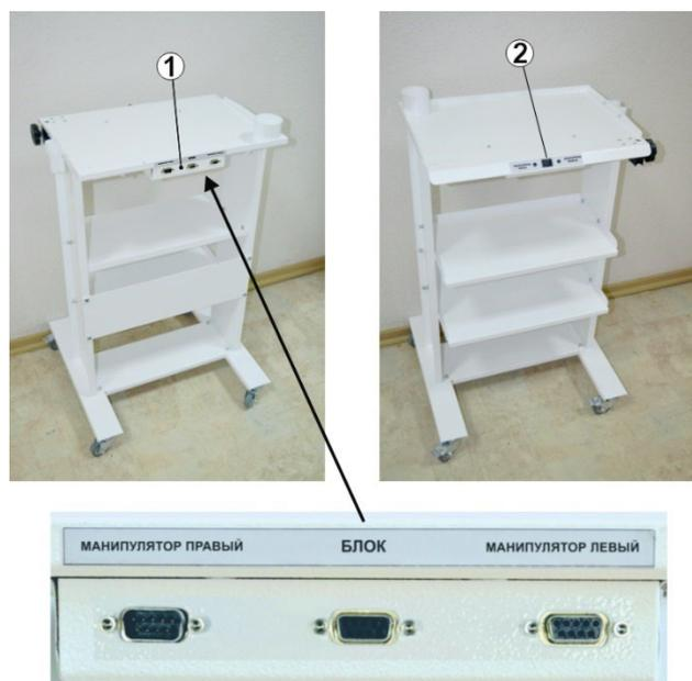
Рис. 10. Расположение разъёмов и переключателя излучателей-матриц на столике для расширения возможностей использования аппарата.
