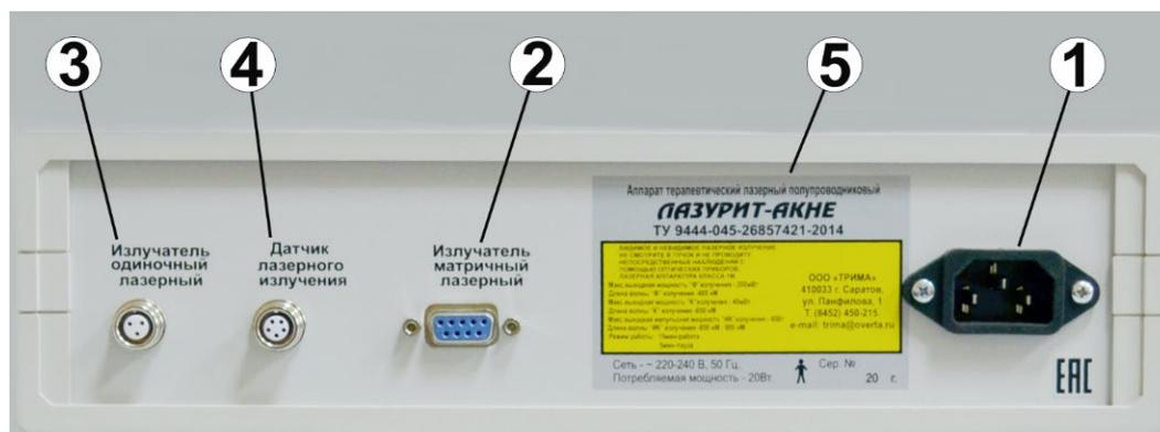
Рис.3. Задняя панель электронного блока аппарата ЛАЗУРИТ-АКНЕ.
