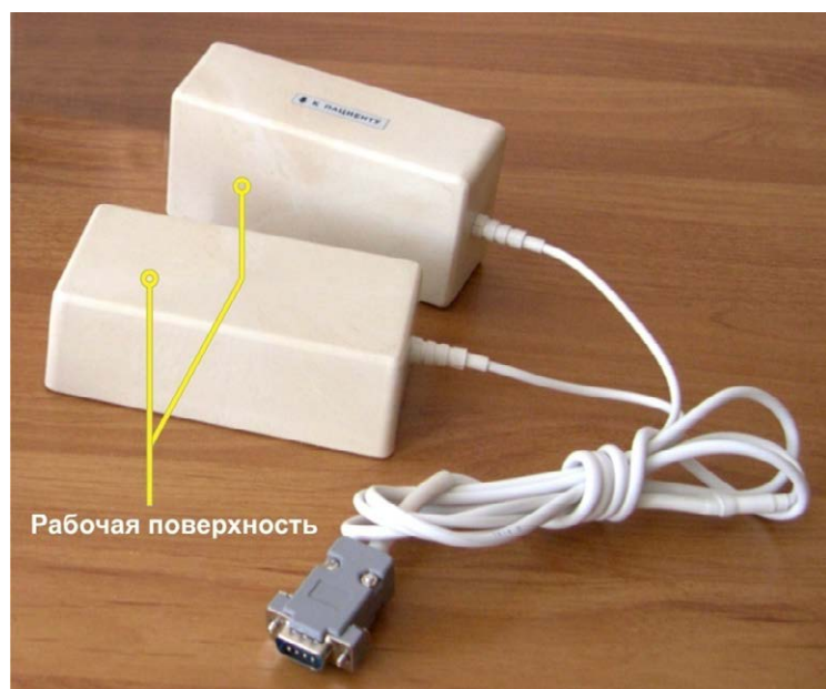
Рис.5. Парный призматический излучатель бегущего магнитного поля
