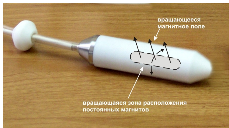
Рис.7. Расположение вращающейся зоны магнитного поля на внешней поверхности корпуса инструмента-вибратора.
