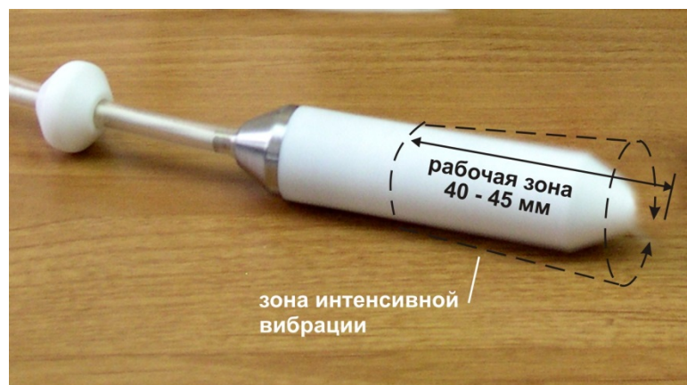
Рис.6. Рабочая часть инструмента - вибратора и зона вибрации.
