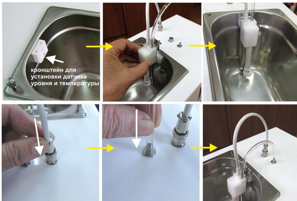
Рис.19. Установка узла датчика температуры и уровня рабочего раствора в ванну для рабочего раствора.
