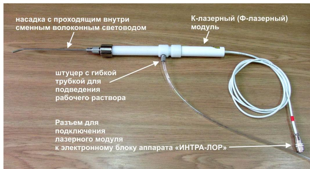
Рис.6. Инструмент для сочетанного воздействия струёй рабочего раствора и лазерного излучения ("Инструмент 1") в сборе.
