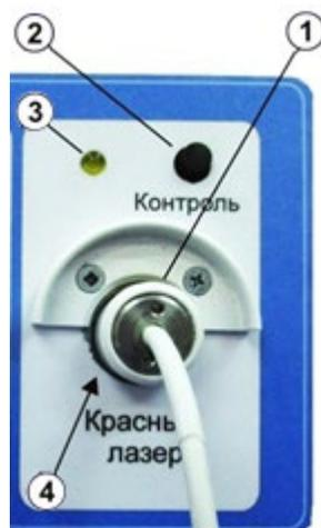
Рис.3. Блок контроля номинальной выходной мощности К-лазерного излучения.
