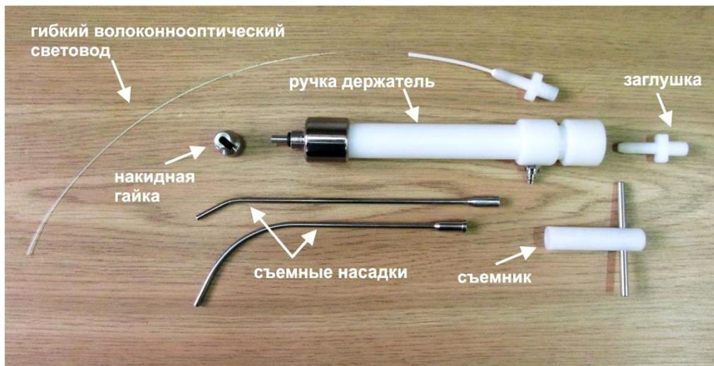
Рис.7. Состав инструмента для сочетанного или раздельного воздействия струёй рабочего раствора и лазерного излучения.
