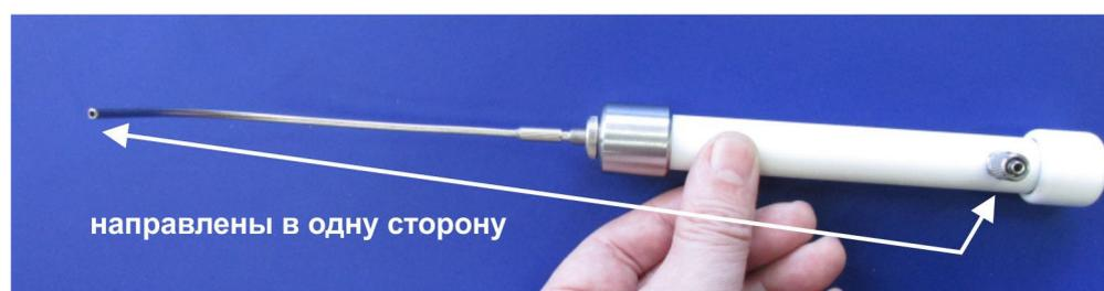
Рис.9. Ориентация загнутого конца насадки относительно штуцера для гибкой трубки.
