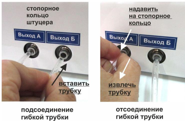
Рис.18. Подсоединение и отсоединение гибких трубок рабочих инструментов.
