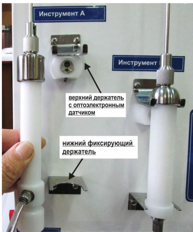
Рис.5. Держатель фиксации инструмента.
