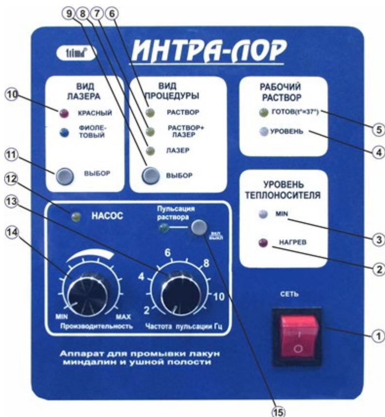
Рис.2. Панель управления блока коммутации и питания аппарата "ИНТРА-ЛОР".
