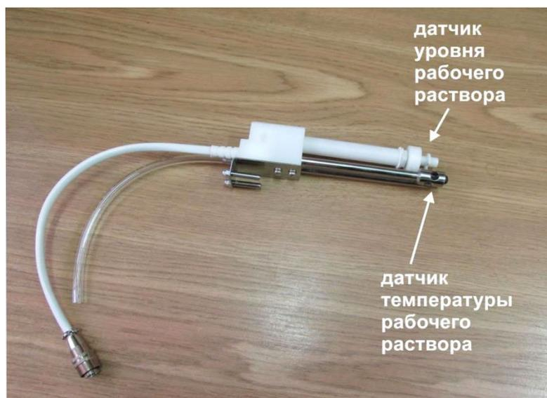
Рис.15. Съёмный узел датчиков ёмкости для рабочего раствора.
