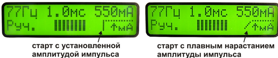
Рис.4. Отображение характера начала следования импульсов тока
