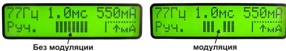
Рис.3. Отображение характера следования импульсов тока
