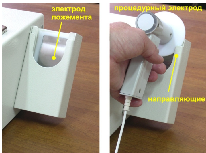
Рис.5. Ложемент для установки процедурного электрода.
