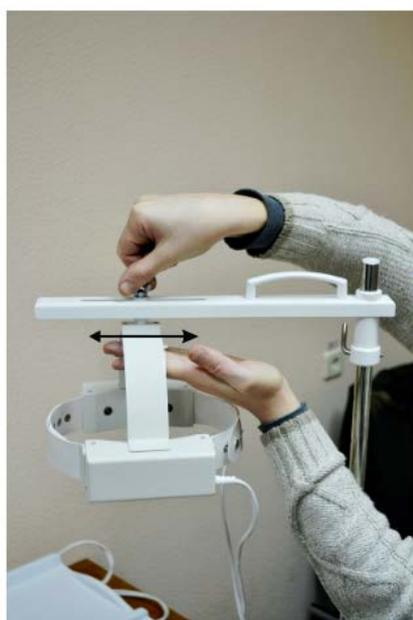
Рис.16. Установка излучателя "ОГОЛОВЬЕ" на кронштейн стойки.
