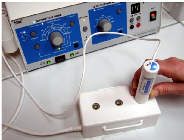
Рис.19. Контроль наличия магнитного поля источников парного призматического излучателя.
