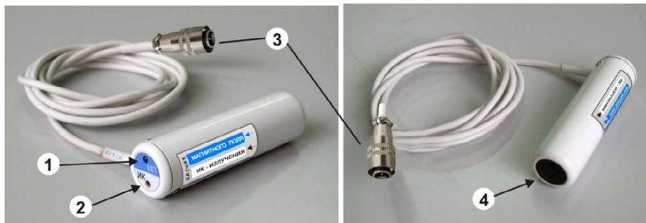
Рис.13. Датчик магнитного поля и ИК-лазерного излучения.
