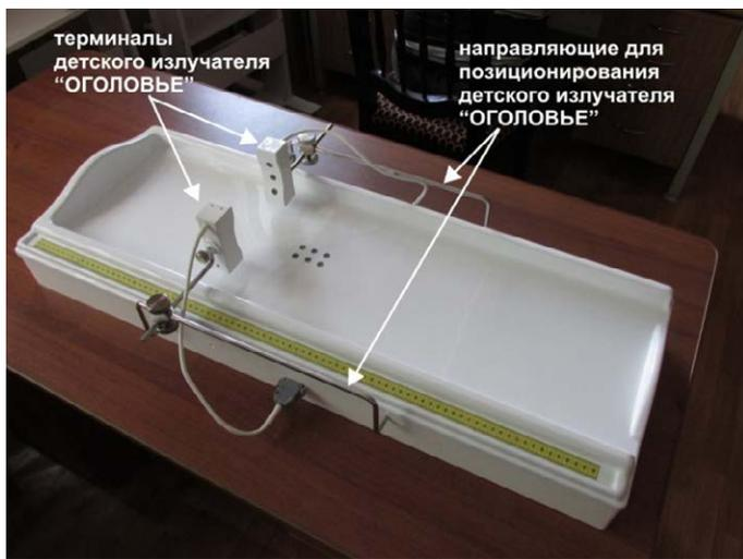
Рис.10. Расположение терминалов магнито-лазерного излучателя детского "ОГОЛОВЬЕ" и направляющих для его позиционирования относительно головы ребенка.
