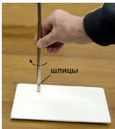
Рис.4. Установка стойки в основание.
