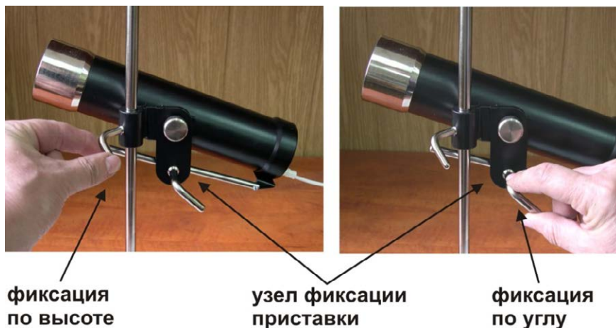
Рис.5. Установка приставки на стойку и её фиксация по высоте и углу.
