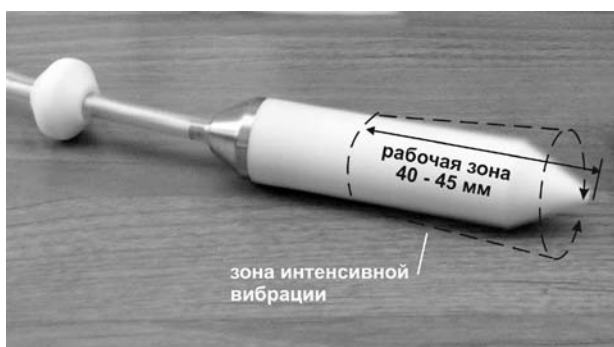
Рис.6. Рабочая часть инструмента-вибратора и зона вибрации.
