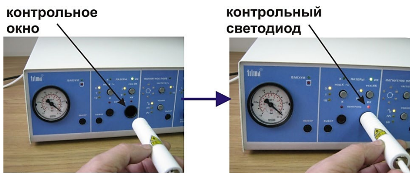
Рис.21. Контроль мощности излучения «инфракрасного» лазера.
