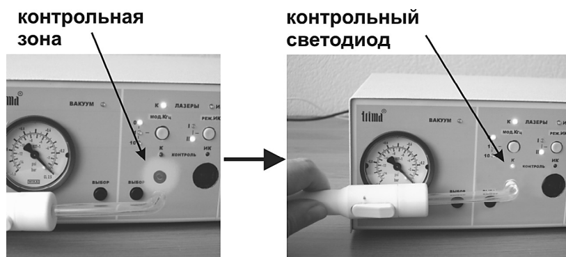
Рис. 20. Контроль мощности лазерного излучения «красного» лазера.
