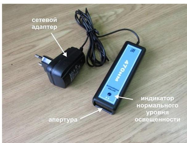
Рис. 9. Датчик контроля уровня освещенности для аппарата "СВЕТОНЯНЯ".
