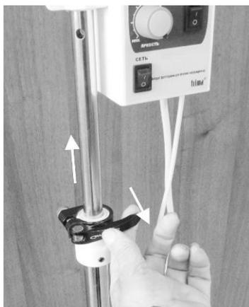
Рис. 4. Изменение положения верхней матрицы по высоте для варианта аппарата ОФТ-"СВЕТОНЯНЯ-М2".
