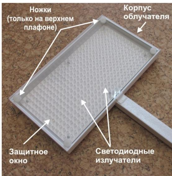
Рис. 5. Матрица светодиодная (нижняя).
