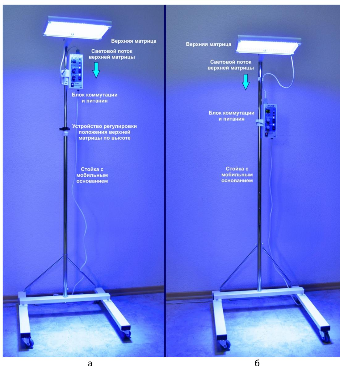
Рис.2. Общий вид вариантов исполнения аппарата ОФТ-"СВЕТОНЯНЯ-М" без нижней матрицы:
