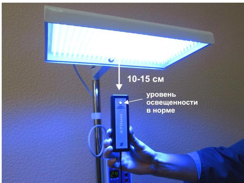
Рис.12. Измерение освещённости.
