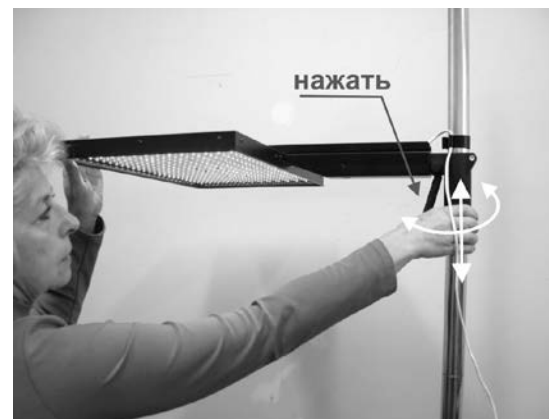
Рис.3. Регулировка положения облучателя
