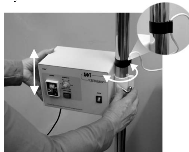
Рис.6. Установка и фиксация электронного блока на мобильной стойке
