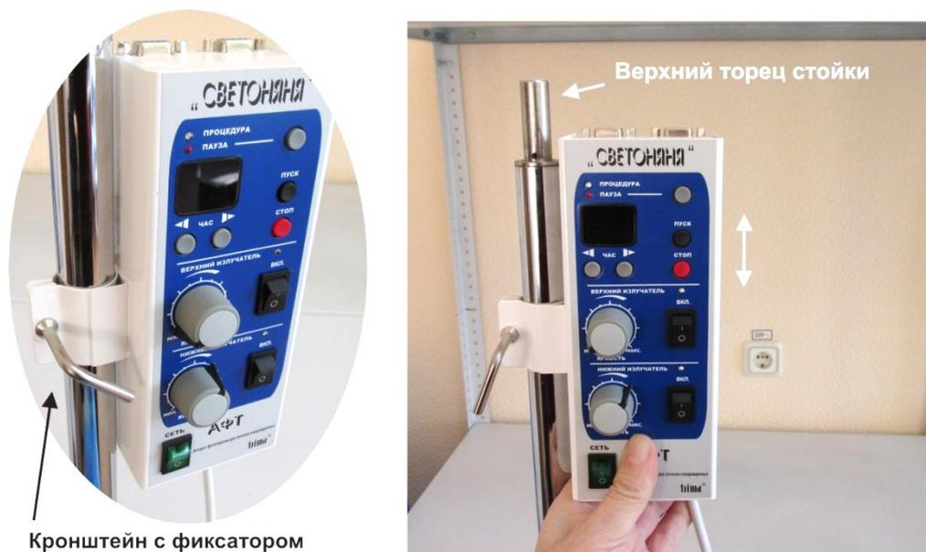
Рис.8. Элементы установки и фиксации электронного блока на мобильной стойке.
