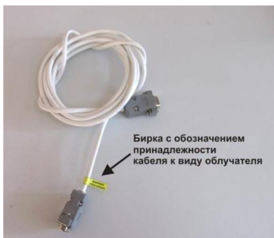
Рис.10. Кабель для подключения верхнего облучателя для его использования через прозрачную стенку инкубатора.
