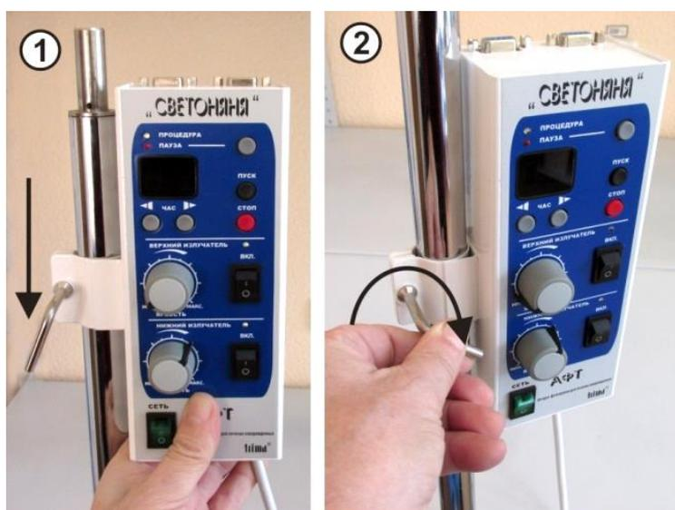
Рис. 20. Установка электронного блока на штангу.
