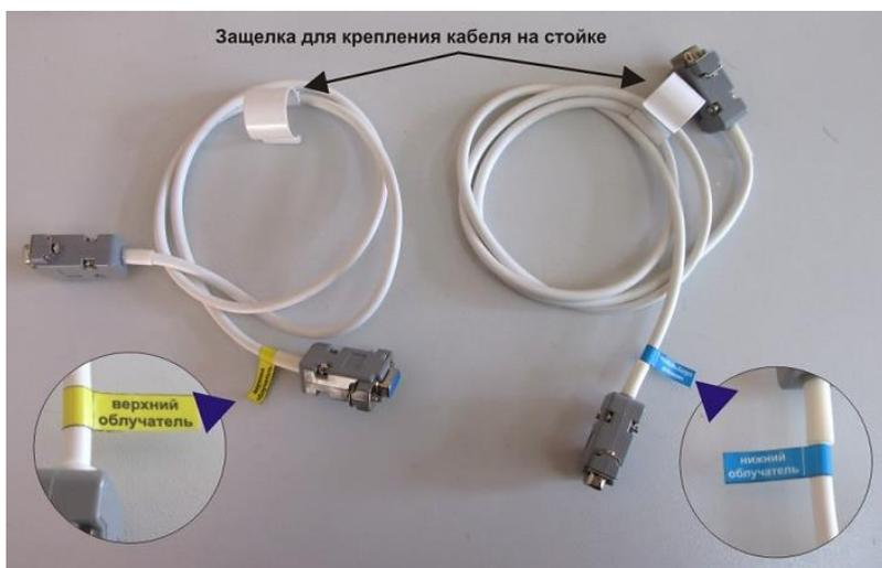
Рис.9. Кабели для подключения верхнего и нижнего облучателей к электронному блоку.
