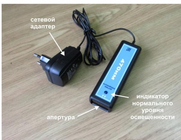
Рис.13. Датчик контроля уровня освещенности для аппарата АФТ-"СВЕТОНЯНЯ".
