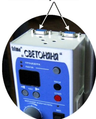
Рис.7. Расположение разъёмов для подключения кабелей питания облучателей на верхней панели электронного блока.
