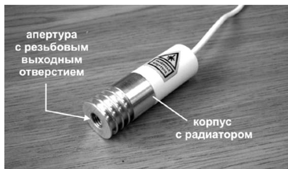
Рис. 3. Лазерный излучатель.
