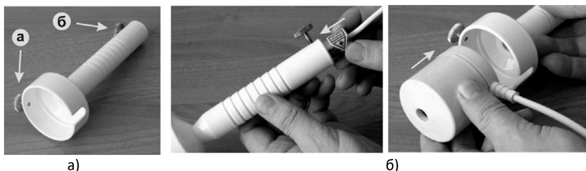
Рис. 11. Общий вид переходника-адаптера (а) и порядок установки лазерного модуля и излучателя бегущего магнитного поля (б).
