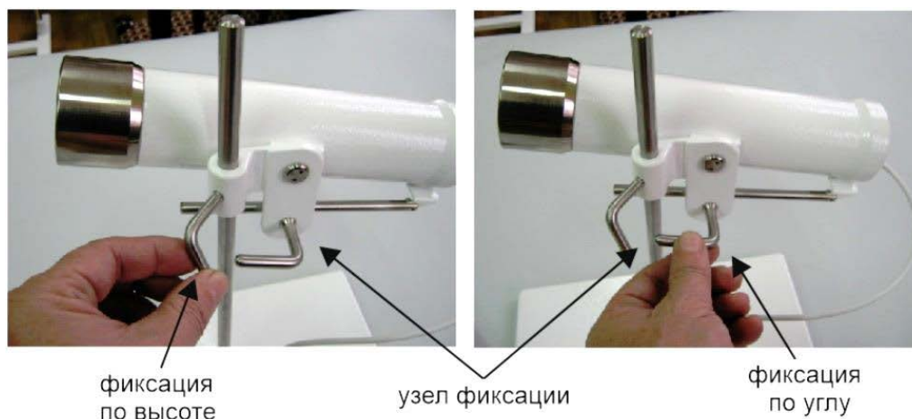
Рис. 5. Установка блока формирования спекл-поля на стойку штатива и его фиксация по высоте и углу.
