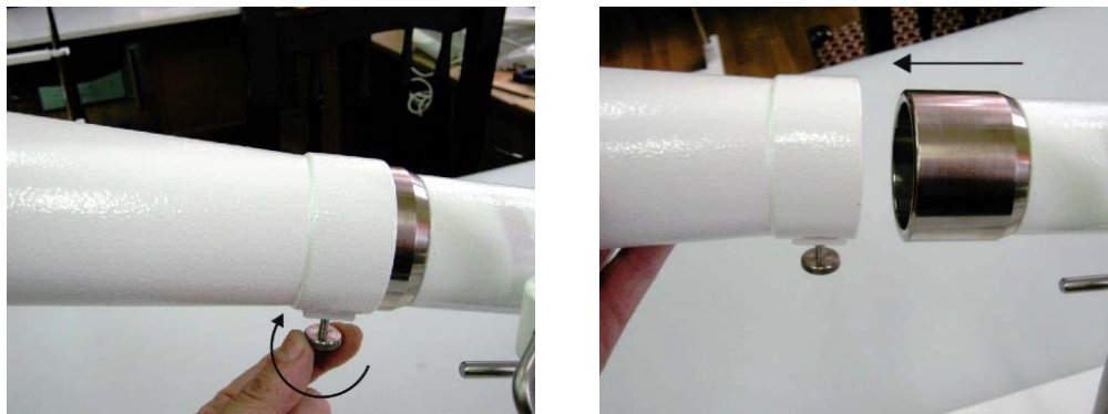
Рис. 6. Снятие тубуса с блока формирования спекл-поля.
