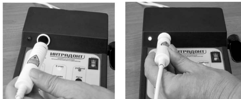
Рис.6. Контроль мощности излучения ИК-лазерного модуля
