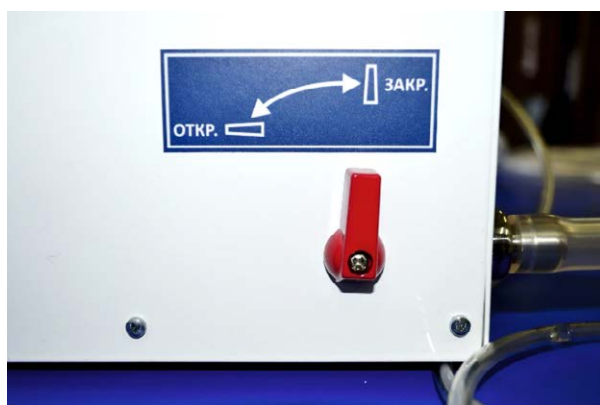
Рис. 6. Узел слива рабочего раствора из ёмкости.
