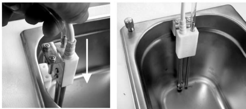
Рис.7. Установка датчика уровня и температуры рабочего раствора
