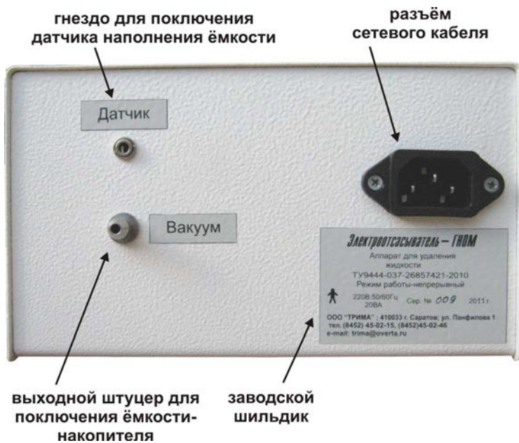
Рис.5. Задняя панель электронного блока.
