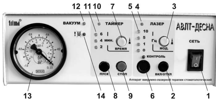
Рис.2. Передняя панель электронного блока аппарата АВЛТ "ДЕСНА"
