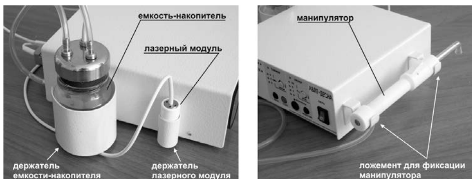
Рис.1(б). Расположение элементов фиксации рабочего инструмента на корпусе электронного блока.
