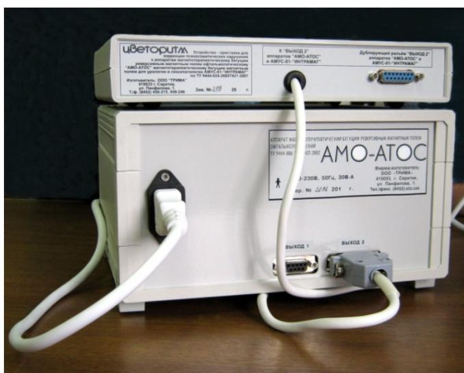
Рис.4. Подключение приставки к аппарату "АМО-АТОС".
