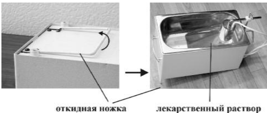
Рис.8. Положение блока ванны при откинутой ножке.
